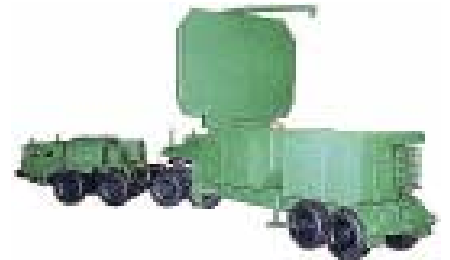
МАЗ/МЗКТ-7410 • 64Н6Е, трехкоординатный радиолокатор обнаружения (РЛО) командного пункта зенитной ракетной системы С-300. (Сиротко, Минск)
